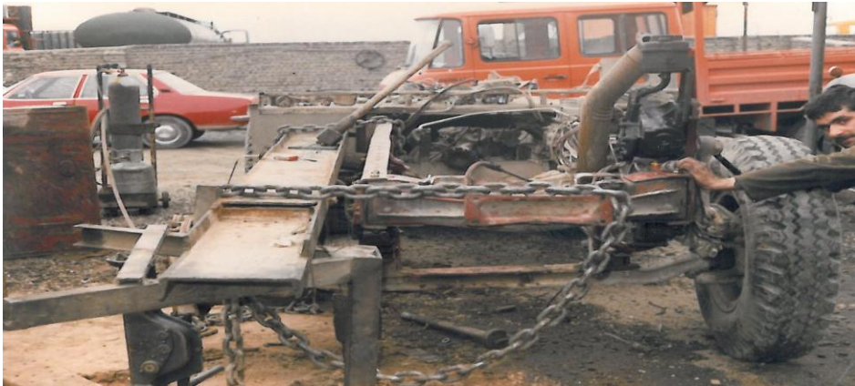
امیر بصائری (آهنگر). تعمیرگاه تهران. گاراژ اصغر بصائری. سال ۶۱. شاسی تریلی کش را صاف می‌کند.
